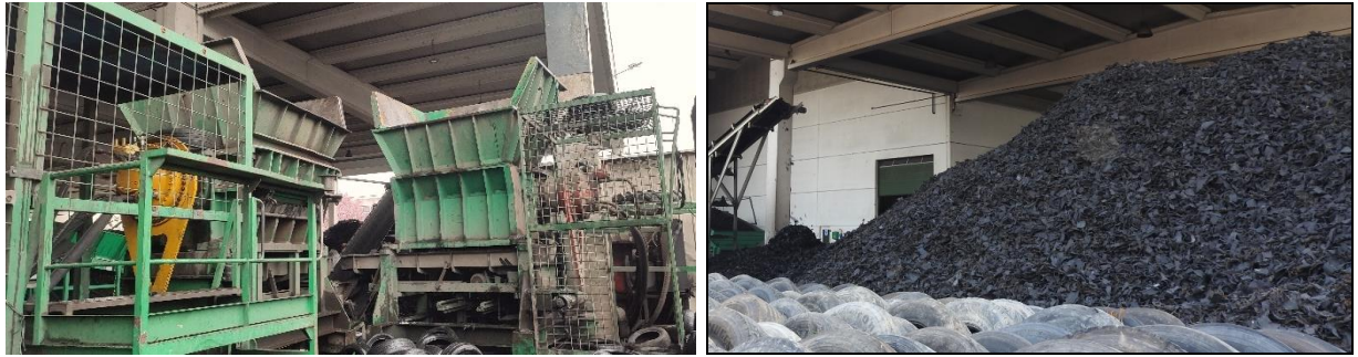
Stari i novi predusitnjivač („šreder“) (lijevo) i gumeni čips koji izlazi iz „šredera“ (desno)
