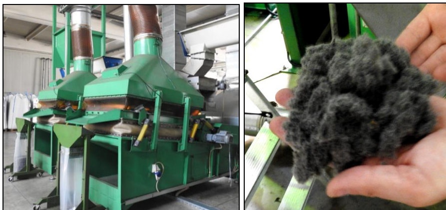
Linija za pročišćavanje gumenog granulata (lijevo) i otpadni tekstil koji se odvaja na liniji
