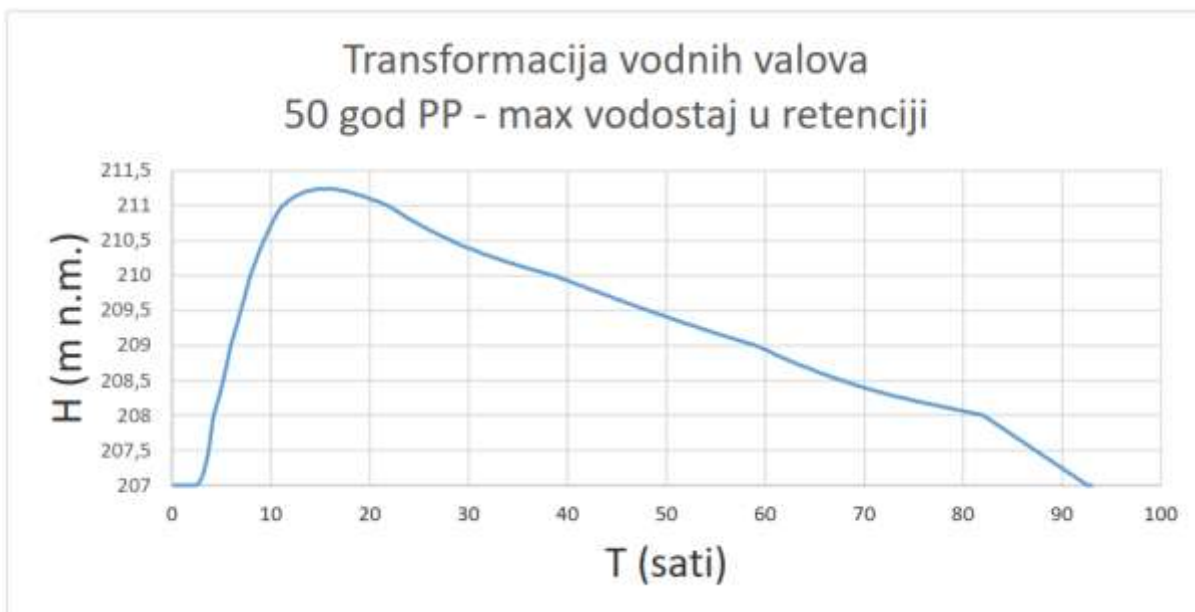
Slika 15. Transformacija vodnih valova kroz retenciju Belščaki 50 god PP – max vodostaj u retenciji (Izvor: Idejni projekt)
